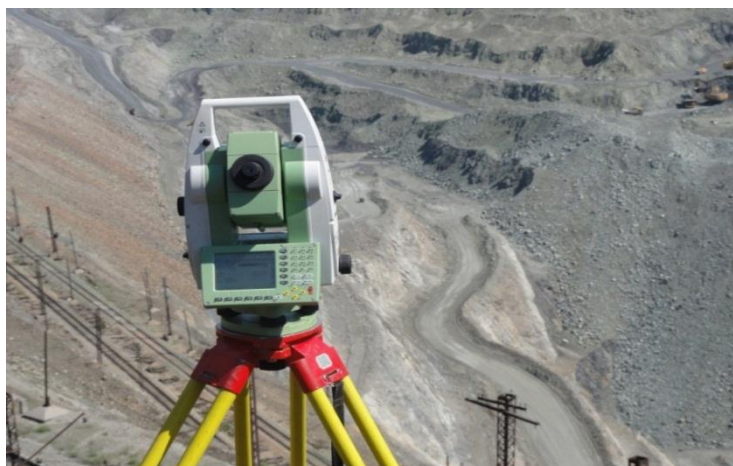
12-сурет - Tca1202 роботталған электронды тахеометрі
